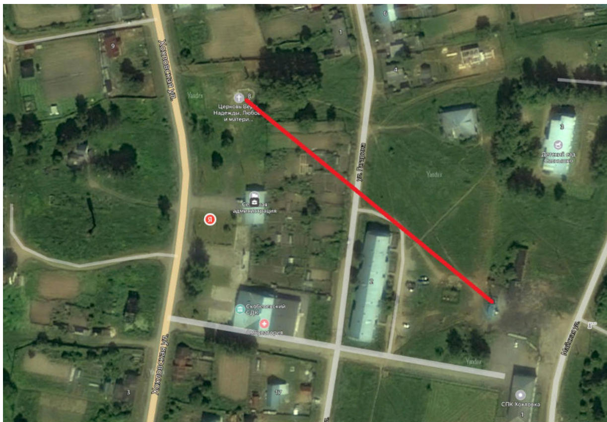
Рисунок 3. Радиус эффективного теплоснабжения котельной д. Скобелевка.
